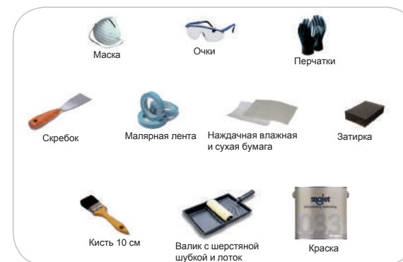
Оборудование для покраски
